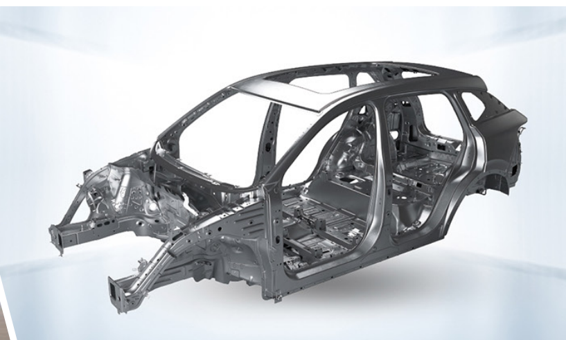
Carrocería compuesta en más del 74% por acero de alta resistencia
