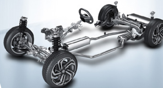
Suspensión delantera MacPherson y trasera independiente de multibrazo
